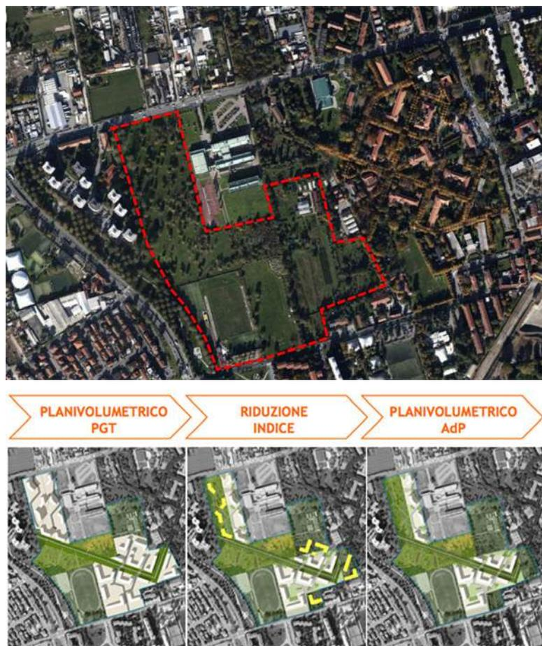
Fig 2 - Planivolumetrico proposto dalla Provincia. In questa immagine è presente un confronto tra le due alternative: la prima con superficie territoriale pari a 155.875 m, la seconda pari a 95.600 mq.
